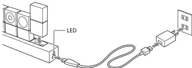
**1 付属のUSBケーブルで、充電クレードルとUSB ACアダプターを接続し、USB ACアダプターをコンセントに接続する。**
